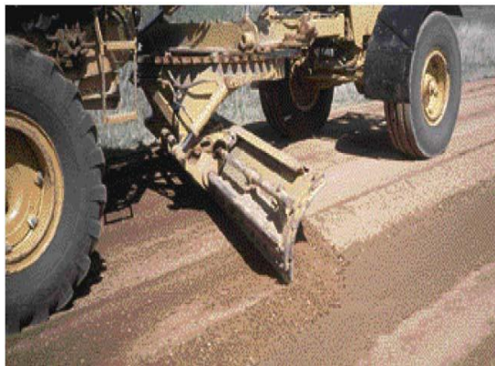
(d) Moldboard Angle and Pitch
